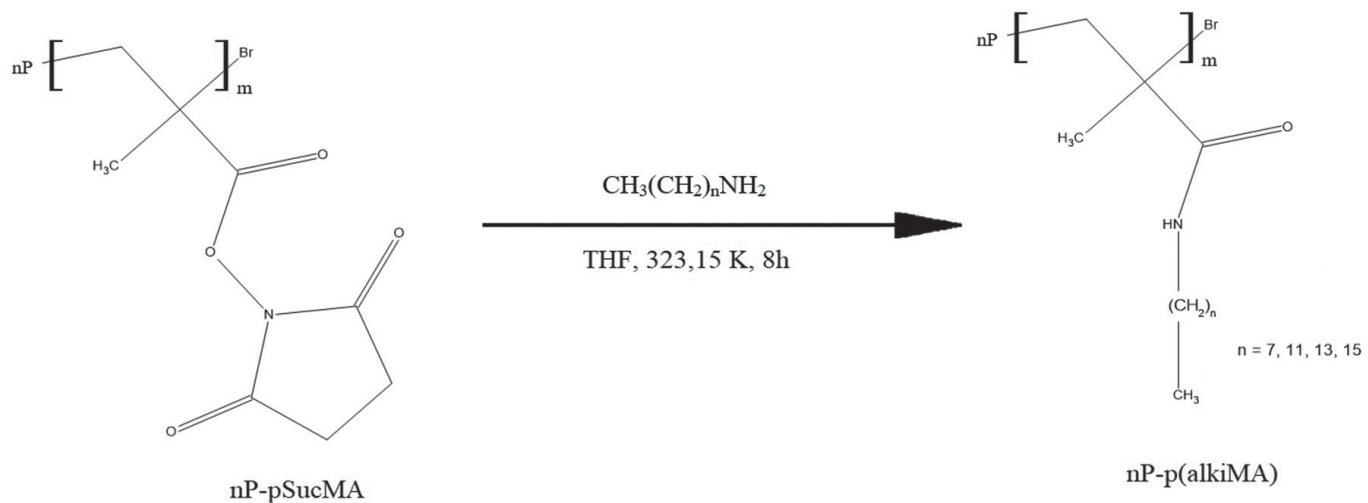
Fig. 4. Process of converting nP-pSucMA to nP-p(alkyl)MA Rys. 4. Proces reakcji przekształcenia nP-pSucMA do nP-p(alkil)MA
