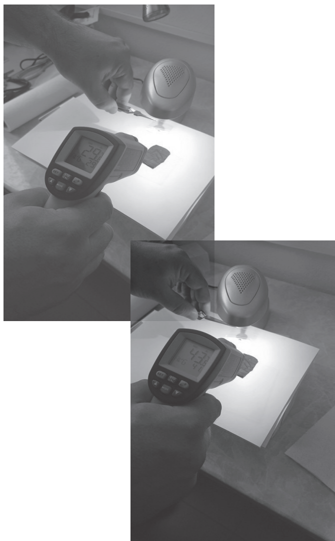
Fot. Autorski eksperyment prof. B. Witkowskiego pokazujący działanie termoizolacyjnej folii; z lewej próba ogrzewania z powłoką, z prawej próba bez powłoki (Źródło: Bartłomiej Witkowski)
