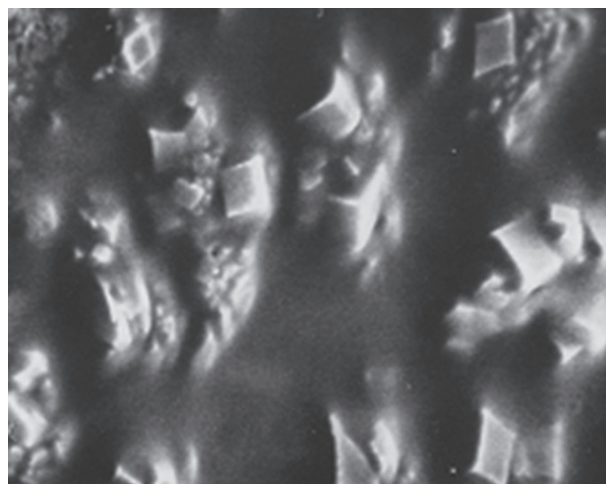
Fig. 4. View of lapping tools surfaces (scanning microscope JSM-S1, 3000×) Rys. 4. Widok powierzchni docieraka (mikroskop skaningowy JSM-S1, 3000×)
