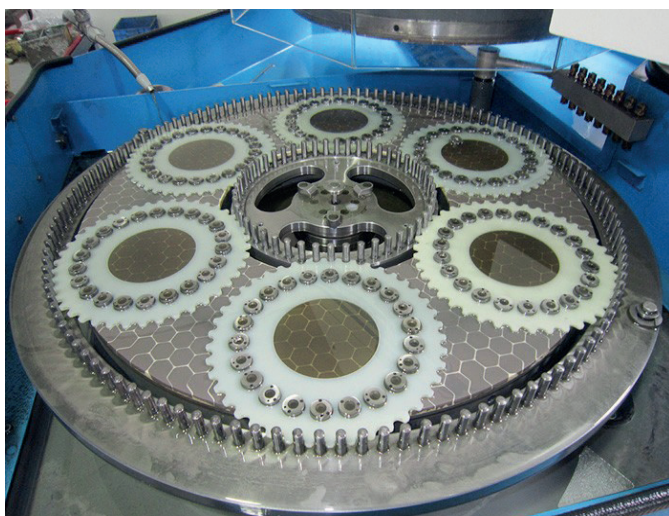
Fig. 10. Grinding on double-disc lapping machine [17] Rys. 10. Szlifowanie na docierarce dwutarczowej [17]
