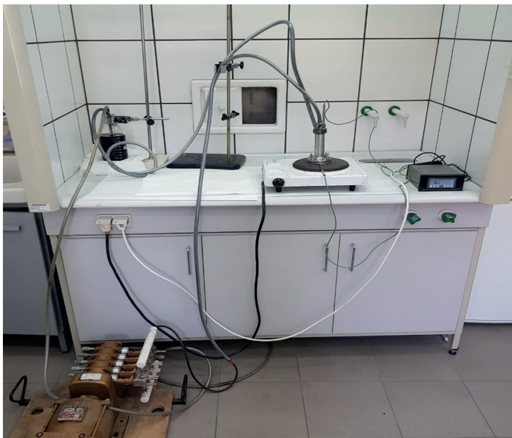
Figure. Components of the crude oil fouling assessment test stand: measuring chamber on the hotplate, temperature gauge and plunger pump Rysunek. Elementy stanowiska do oceny foulingu rop naftowych: komora pomiarowa na płycie grzewczej, miernik temperatury i pompa nurnikowa
